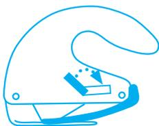
Levantamos el asa y giramos hacia abajo hasta que su punta se apoye en el botón de cambiar la cuchilla.
