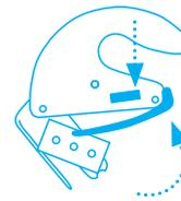
Volvemos a apertamos el asa y, al mismo tiempo, empujamos hacia atrás el pie metálico en el mango hasta que encaje. A continuación, comprobamos que está firmemente colocado.
