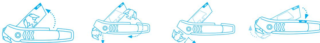
Abra el cargador de la hoja. El cabezal de la hoja montado se soltará automáticamente.
