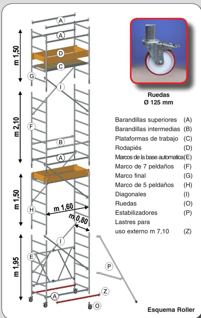
**ROLLER 7.10 m.** Después de añadir el módulo C es posible añadir el módulo D de 2.10 m para conseguir una altura total de 7.10m (8.10 m de altura de trabajo). Los marcos, equipados con peldaños cada 30 cm permiten el acceso seguro de los operarios a la plataforma de trabajo (conforme al estándar europeo UNIEN 1004) sin necesidad de utilizar escaleras interiores.
