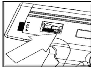
Realice siempre una fijación de prueba usando primero una carga de nivel de potencia más bajo (amarillo).
