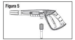
6. Conecte la manguera de alta presión a la salida de agua.
