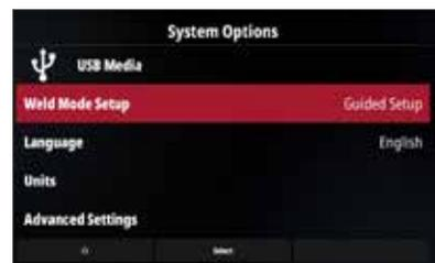
Siguiendo las indicaciones de la pantalla, seleccionando el tipo de material, el grosor y el tipo de junta, **la guía de configuración establecerá todos los parámetros adecuados para una soldadura fácil y de calidad.**
