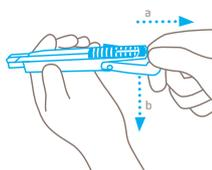
Estire el botón de cambio de hoja hacia atrás como lo indica la flecha (a), pliegue el extremo del mango hacia abajo (b) y **mueva la hoja fuera del mango usando el desplazador**.
