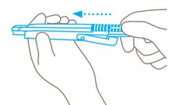
Por último, desplace dentro el mango la parte interna junto con la hoja y pliegue el extremo del mango hacia arriba. A modo de prueba, libere y vuelva a posicionar la hoja para confirmar que todo funciona correctamente.
