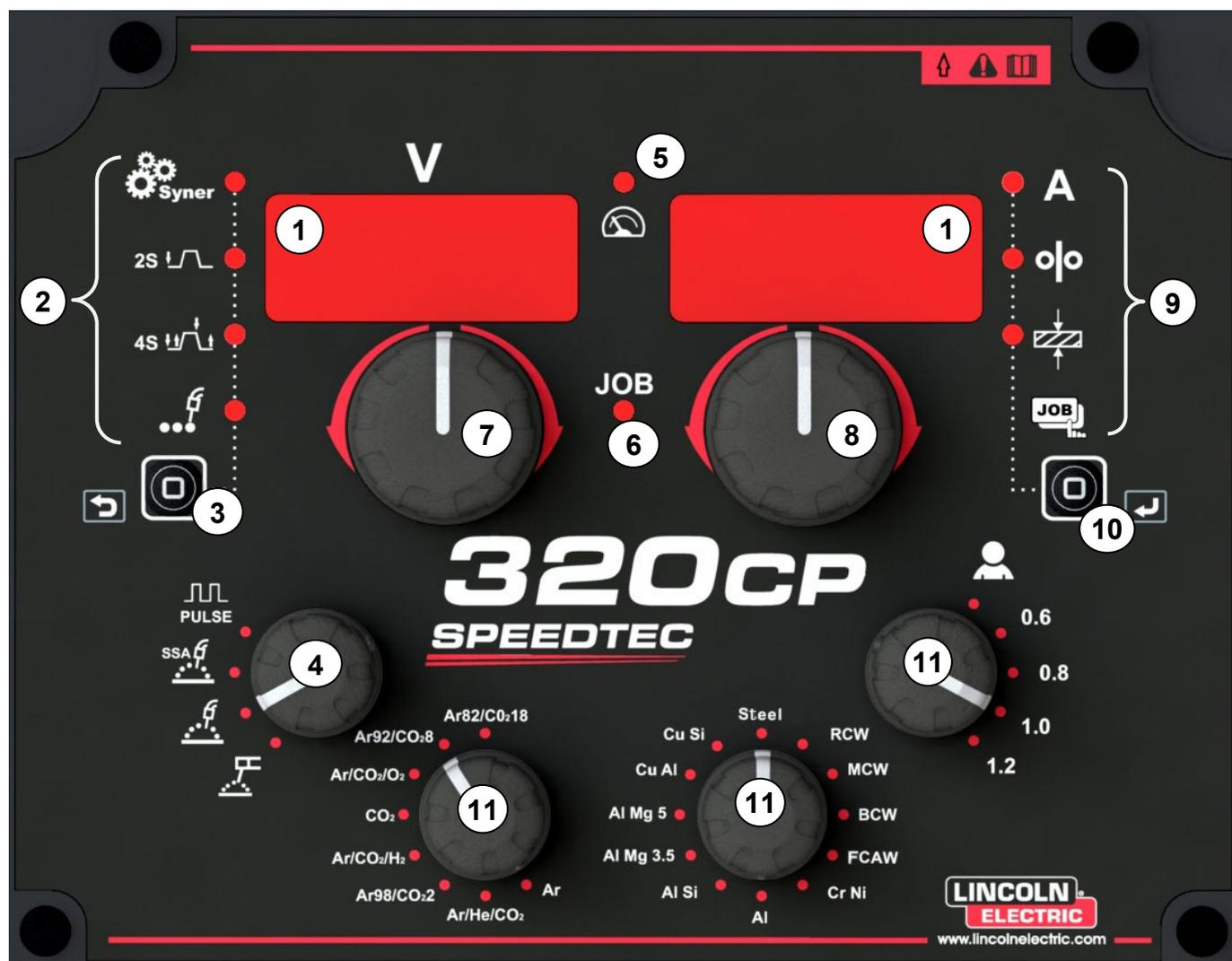
Pantalla izquierda: Tensión, Pantalla derecha: Corriente/Velocidad del cable/Espesor del alambre
