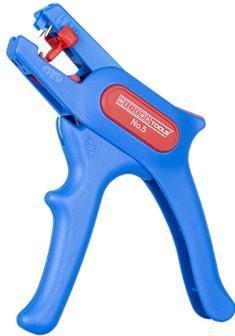
WEICON TOOLS Tenaza Pelacable No. 5 La herramienta pela todos los conductores de hilo y cable de uso habitual de 0,2 a 6,0 mm<sup>2</sup> (24 – 10 AWG). Dispone de un tope ajustable de longitud entre 5 y 12 mm. El tope de longitud es extraíble si fuera necesario. Una cuchilla lateral fácilmente accesible que trabaja en diámetros de cable hasta 2 mm, está integrada en la herramienta. Las cuchillas son intercambiables. El bajo peso de la No. 5 garantiza un trabajo sin fatiga.
