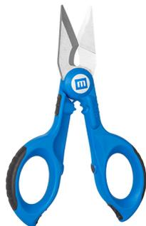
La tijera sirve para cortar y quitar el aislamiento de cables Cu/Al así como para fijar terminales de 0,5 a 4 mm<sup>2</sup>. Las hojas de acero inoxidable de alta calidad están templadas a 55 HRC y por lo tanto son muy resistentes al desgaste. El dentado fino de las hojas garantiza un corte enrasado, antideslizante y preciso. Los mangos antideslizantes de dos componentes, hechos de un plástico reforzado de fibras de vidrio y resistentes a golpes, aseguran un trabajo seguro.
