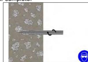
8. La resina sobrante saldrá del orificio uniformemente alrededor del componente metálico indicando que el orificio está lleno.
