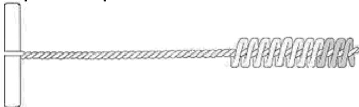
**Anclaje por adherencia de acero MO-VS**
