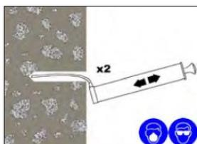
**Si se acumula agua en el orificio después de la limpieza inicial, deberá eliminarse dicha agua antes de inyectar la resina.**
