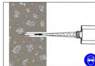
6. Insertar la cánula (retenedor de resina / tubo alargador si es necesario) hasta el fondo del orificio. Comenzar a inyectar la resina y retirar lentamente la cánula asegurándose de que no queden burbujas de aire mientras se retira la cánula. Rellenar aproximadamente  $\frac{1}{2}$  o  $\frac{3}{4}$  del orificio y retirar la cánula por completo.
