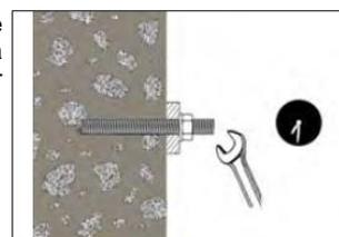
**Anclaje por adherencia de acero MO-VS**
