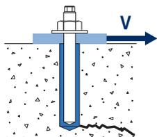
**Resistencia de cálculo del acero a cortante**
