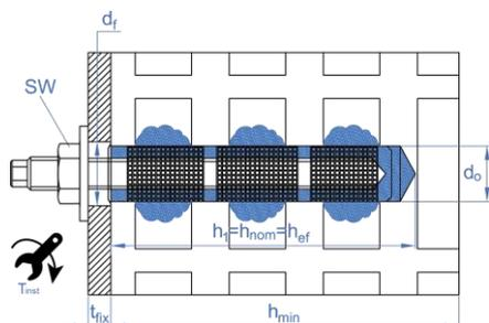
Para realizar fijaciones en ladrillos huecos se deberá usar un tamiz plástico para evitar que la resina se caiga por los agujeros interiores.
